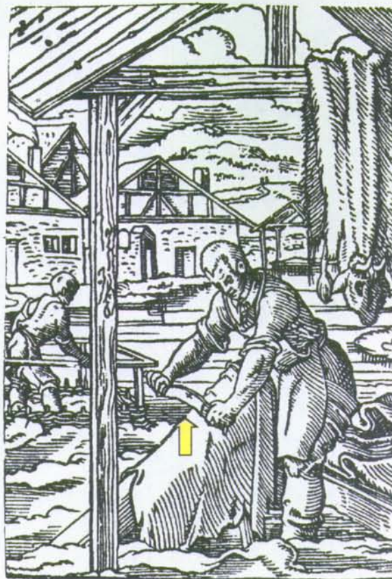
Gravat medieval on s'efectua l'operació de treure la carnassa de la pell, sobre el ferro de la post. (Revista Piel núm. 69-70, 1949)
