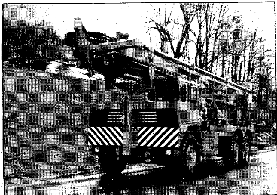
La INGERSOLL-RAND -T5, una màquina potent i modernitzada per a perforacions a terrenys durs. (Fotos JOAN SEGUR).
