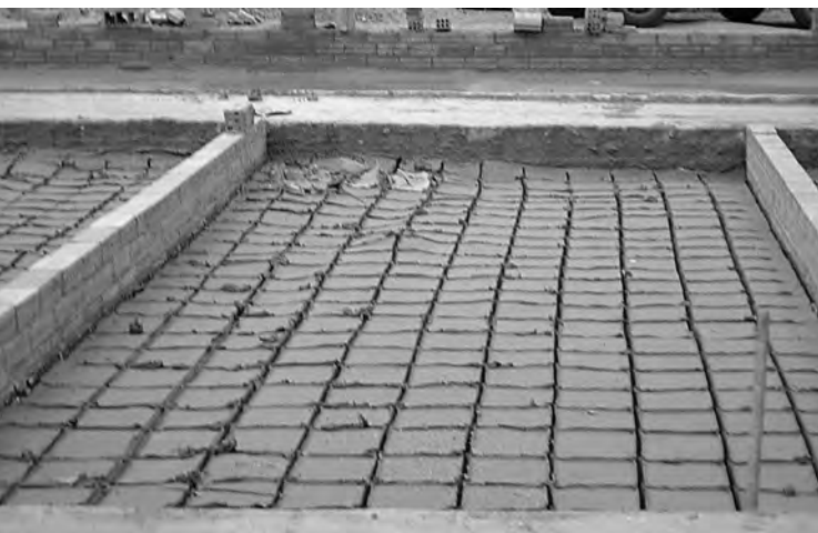
Bassa on encara actualment es diposita el fang que després s'utilitzarà en el procés de producció. Fotografia de Violeta Quiroga.
