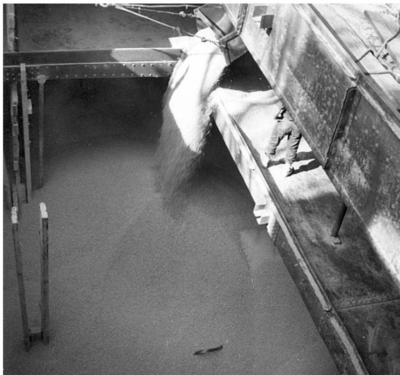
Foto 12. Abocament de blat des de l'entrepont fins al mig de la bodega amb una pala d'arrossegament, 1963. APB.
