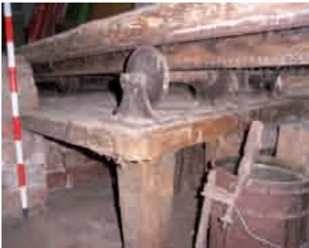
Detall de la part inferior de la plataforma de fusta i ferro de la galera.
