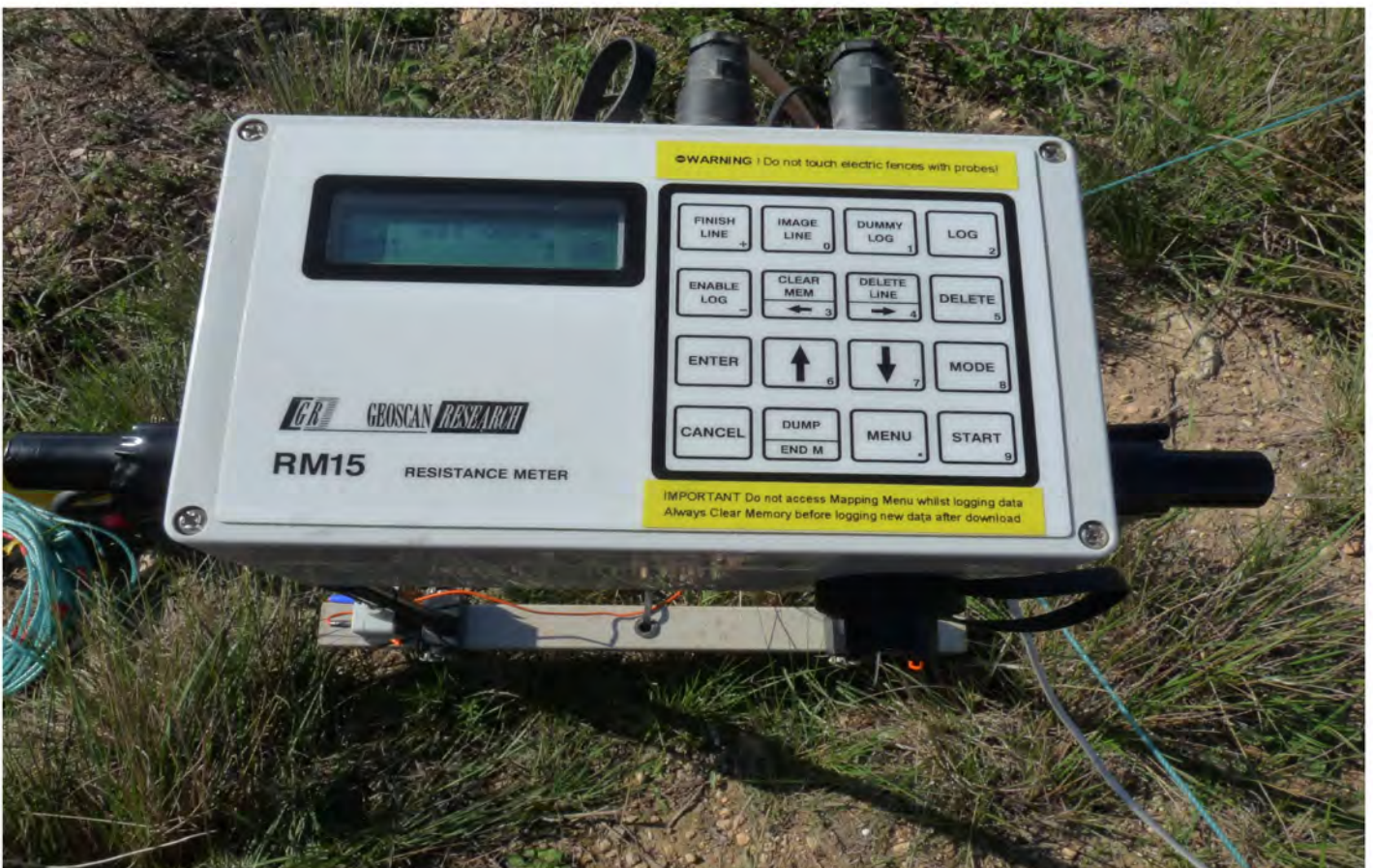
Làm. IV Imatges del resistímetre RM-15 utilitzat per a la prospecció geolèctrica a la Costa de la Serra
