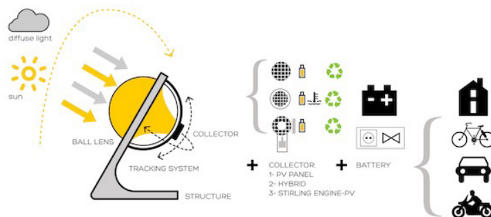
Figura 2. Il·lustració que mostra el funcionament del Rawlemon . Podem observar com la llum entra per la lent, que focalitza en un xicotet panell. El panell, que té un sistema de seguiment de l'òrbita solar, emmagatzema l'energia obtinguda en una bateria. Una energia que es pot aprofitar després.
