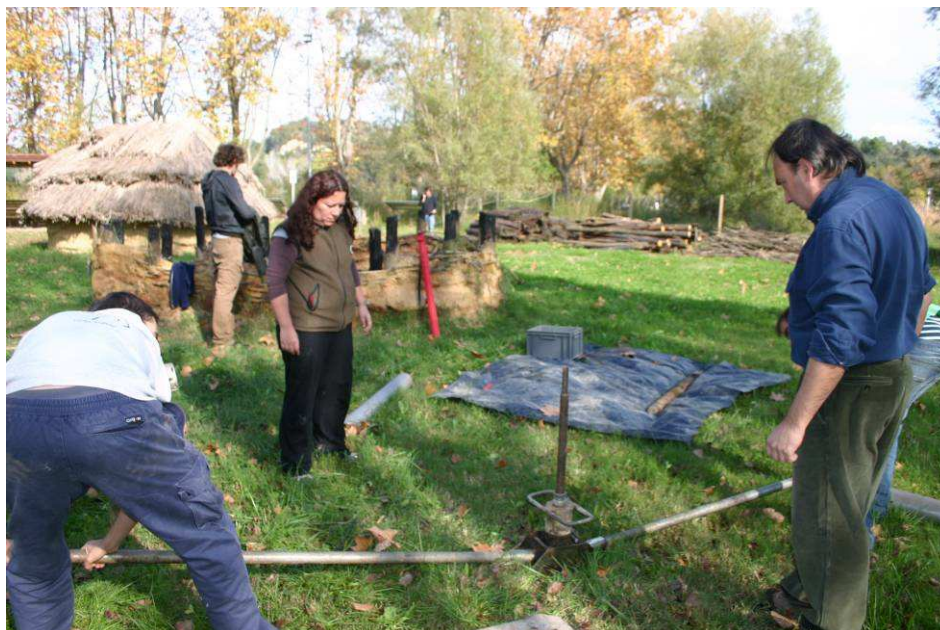
Figura 3.- extracció de la columna amb l'ajut de gat hidràulic
