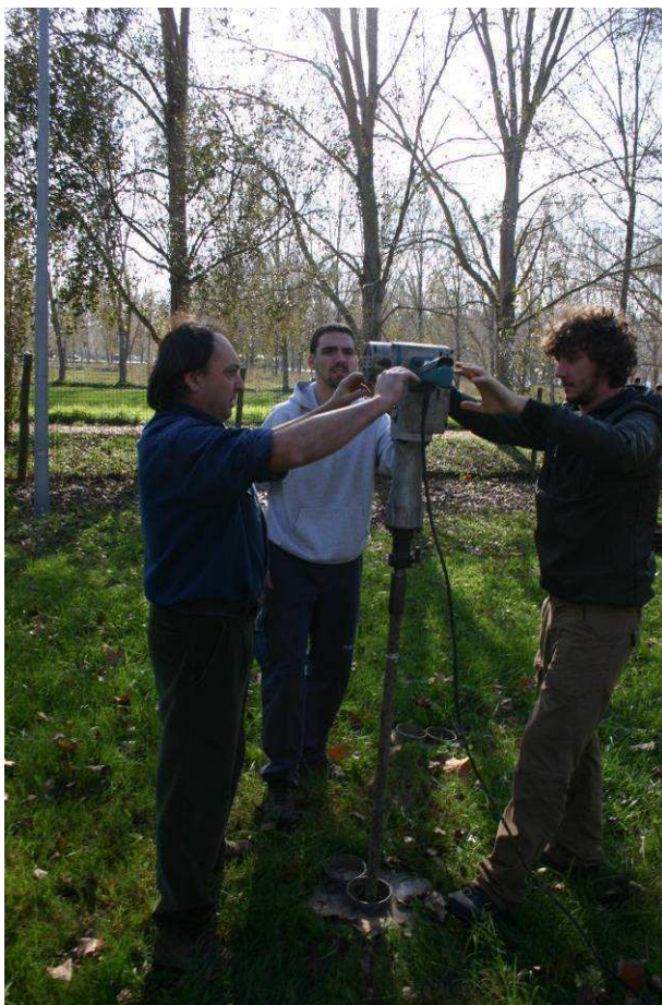
Figura 2.- Sonda pneumàtica, detall del martell.
