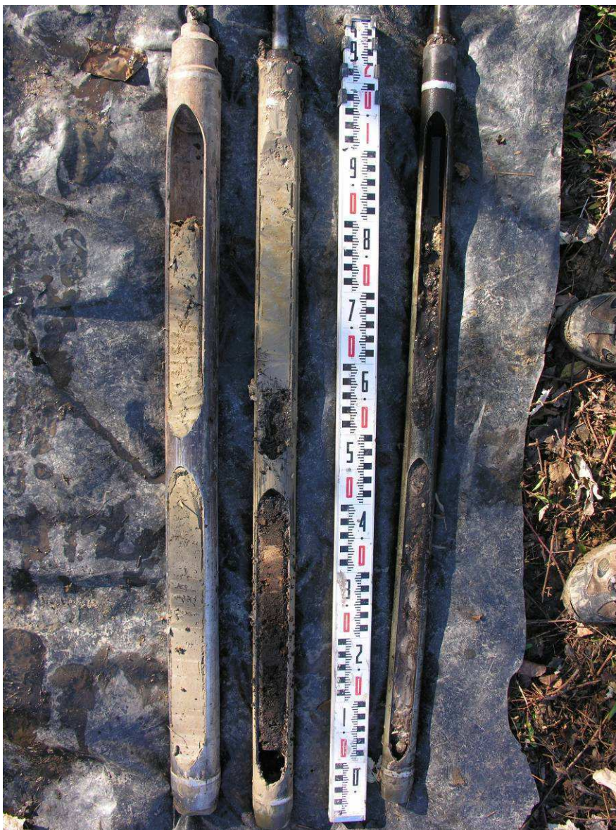
Figura 10.- sondeig número 29 detall de l'estratigrafia dels tres metres de profunditat. La bateria de l'esquerra correspon a la primera extracció (0-100 cm) la del mig a la segona (100 a 200 cm) i la de la dreta a la tercera (200-300 cm).
