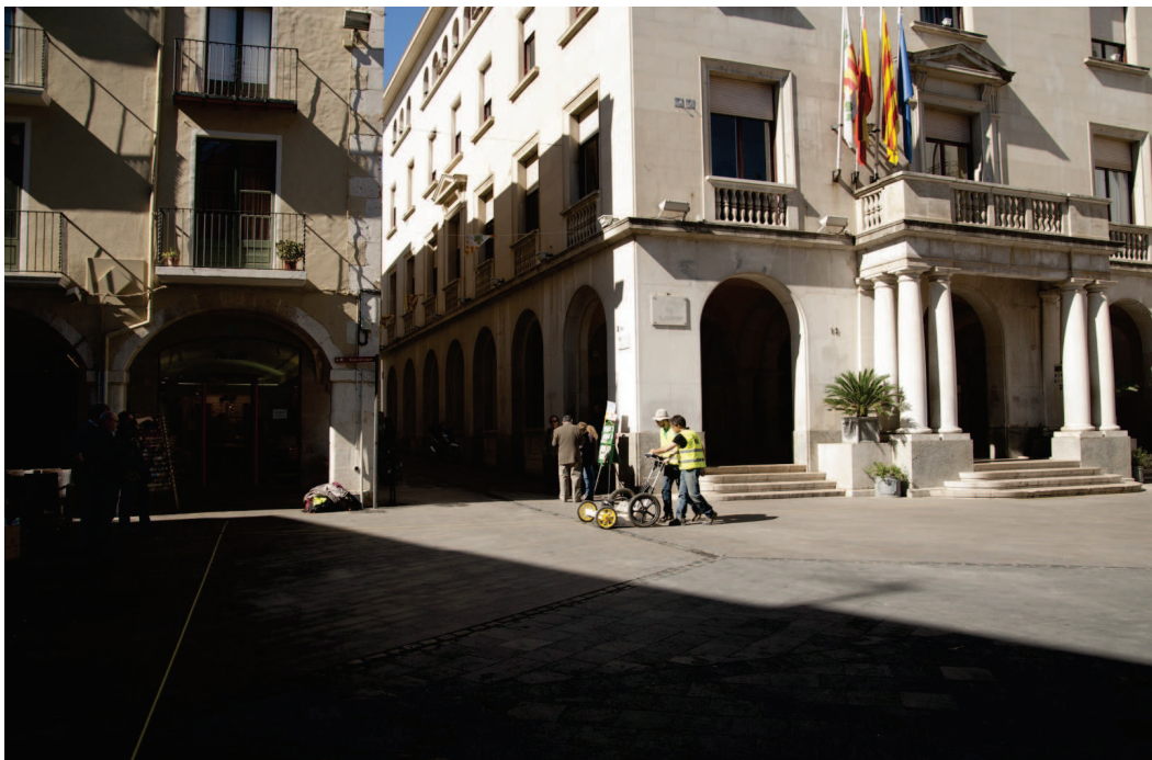
Figura 4 Sistema IDS Hi-Mod 200+600MHz durant les tasques de prospecció a la Plaça de l'Ajuntament
