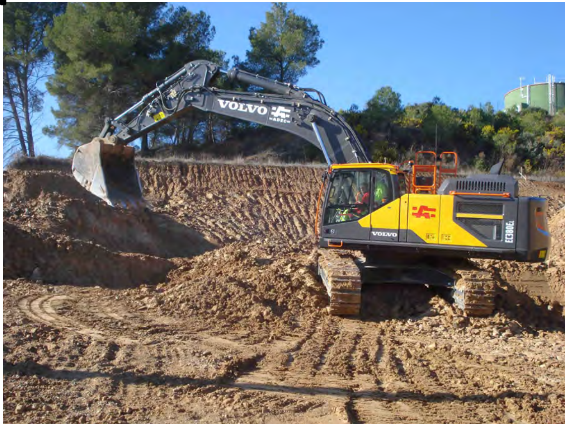
Figura B.6. Imatge de la giratòria Volvo EC380E carregant sediments miocens a la part més al S del sector PCM el 09/01/18.
