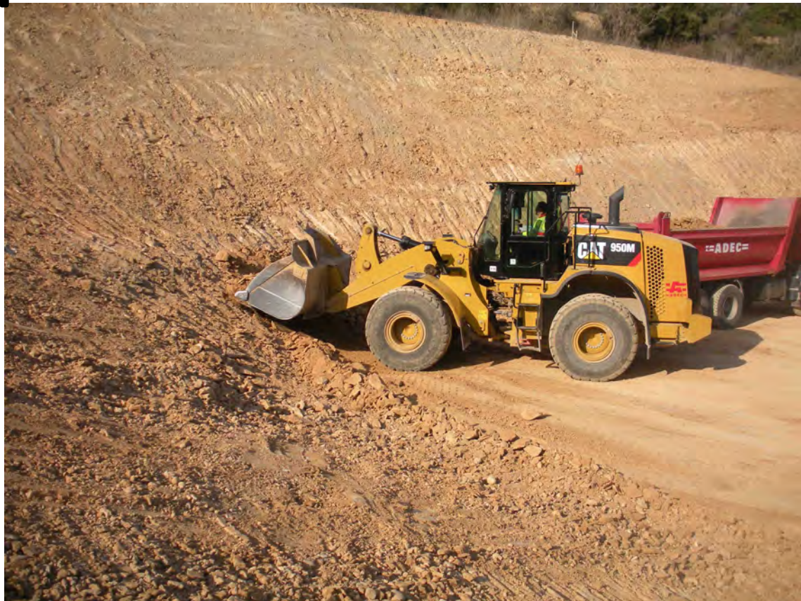
Figura B.15. Imatge de la pala de càrrega frontal Caterpillar 950M carregant sediments miocens a la part N del sector PCM el 22/02/18.
