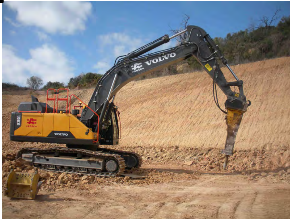
Figura B.13. Imatge de la giratòria Volvo EC380E excavant sediment miocens a la part N del sector PCM amb el martell el 19/02/18.
