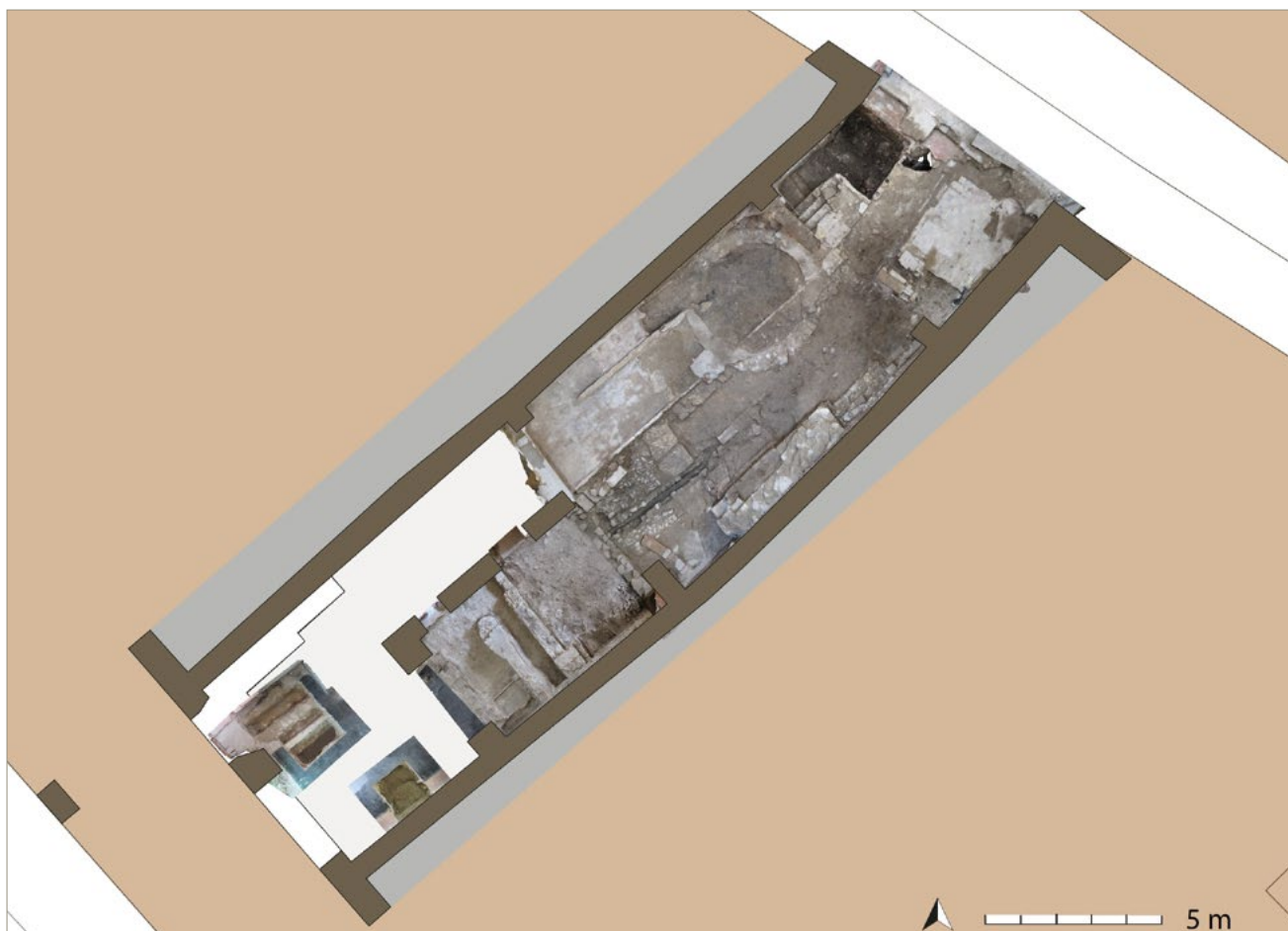
Figura 2. Planta de la finca intervinguda, amb superposició d'algunes de les estructures i nivells documentats. Destaca, a l'angle nord-oest, el rentador bastit l'any 1771.
