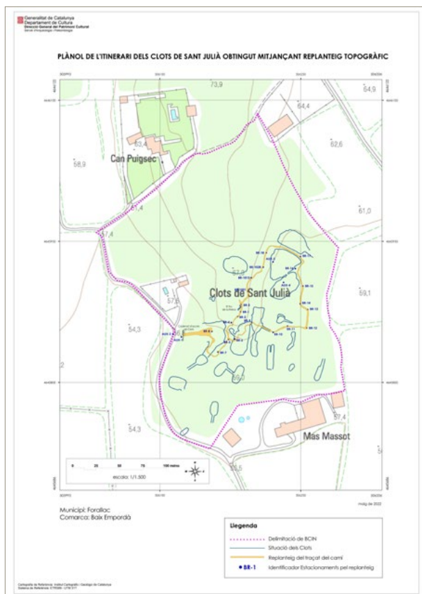
Figura 2. Plànol amb el traçat del camí obtingut a partir de la xarxa d'estacionaments amb GPS i Estació Total. La xarxa d'estacionaments amb GPS es va utilitzar com a referència per fer els treballs d'escaneig 3D.
