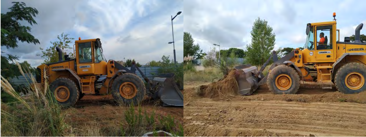
Figura 3. Pala de càrrega frontal Volvo L60E amb N a sèrie L60EV2076, amb pala Bucket Model 938226 i matrícula E5748BCY. Aquesta màquina s'emprà per desbrossar i arrencar els primers centímetres del sediment remogut i terra vegetal, veure figura 3
