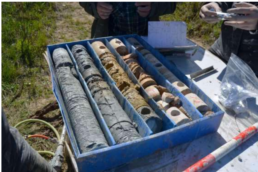
Figura 11. Testimoni de sondatge corresponent als Casots. Els sondatges es parteixen en trams de 60 cm de llarg que es dipositen en caixes especials per al seu emmagatzematge. Cada caixa pot contenir fins a 5 trams de 60 cm. En aquest cas els testimonis de sondatge consten sobretot de lutites grises i rogenques. Les capes més compactes a la dreta són calcàries lacustres vermelloses. Els orificis circulars que presenten són les mostres preses per a l'anàlisi de paleomagnetisme. Noteu la continuïtat del testimoni de sondatge.
