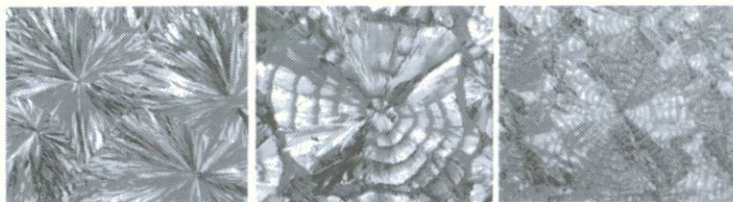
Cristalls d'aspirina vistos amb llum polaritzada a 360 augments (esquerra i centre) i a 50 augments (dreta).
