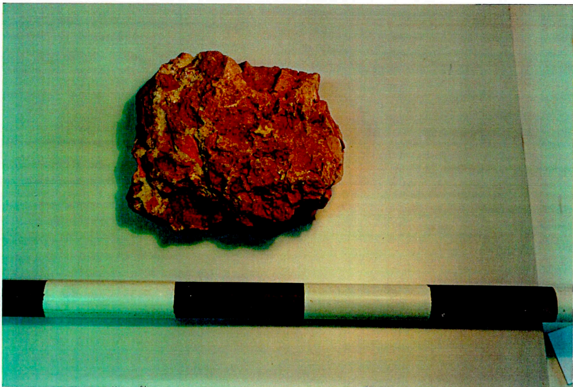
FOTO 20: Fragment de paviment d' opus signinum , revers on s'observa el preparat o rudus (CP-99-30)
