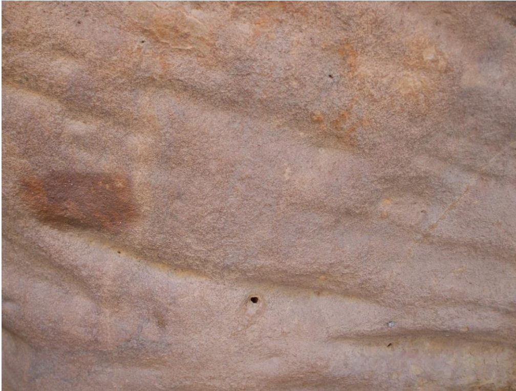
Zona de la dansa amb la prova de l'any 2000. La presència de sals insolubles en superfície ha dificultat la neteja del conjunt.
