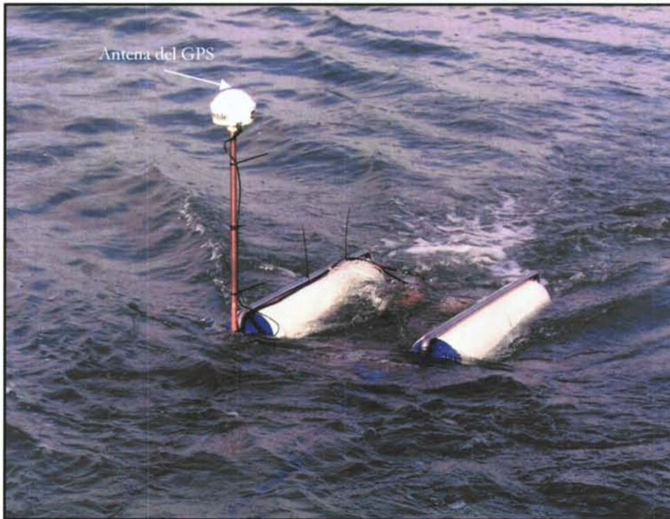
Fig. I.4. Antena del GPS-Diferencial utilizado sobre el catamarán.
