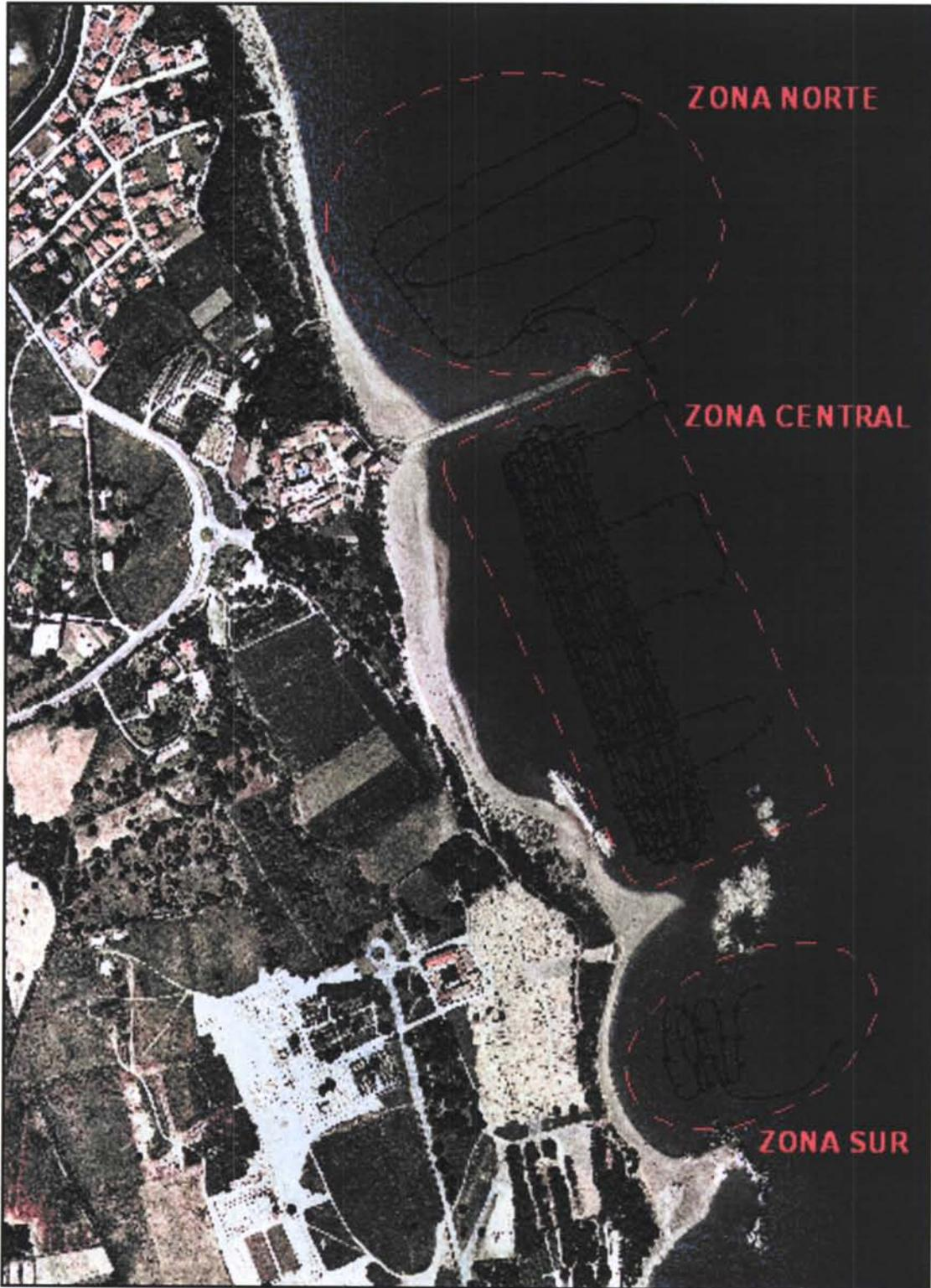
Figura I.19. Mapa de navegación y fixes del geopulse y receptor alternativo para geopulse a 100Julios.
