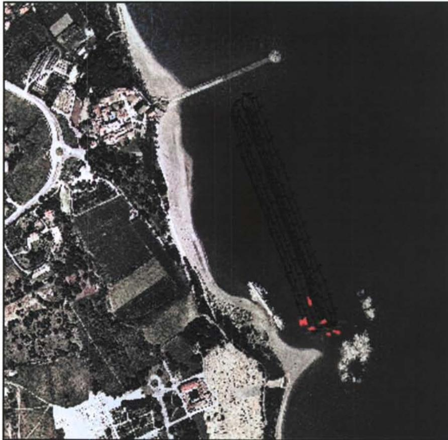
Figura I.18. Mapa de navegación y fixes del geopulse y receptor alternativo para geopulse a 200Julios.
