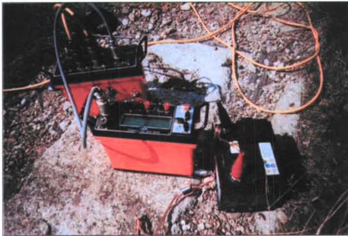
Figura 1. Sistema d'adquisició d'informació (ABEM- Terrameter SAS-4000) utilitzat a les prospeccions geofísiques. El dispositiu es connecta a 64 elèctrodes d'acer inoxidable que es claven al terra i s'uneixen amb dos cables blindats per evitar els efectes de la conducció.
