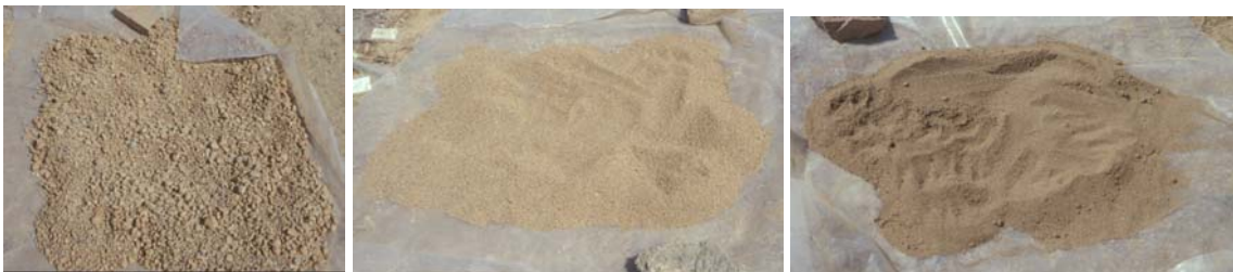
Figura B29. Detall de concentrats de diferent granulometria assecant-se al sol: groller (esquerra), mitjà (centre) i fi (dreta).
