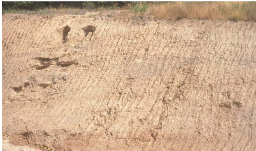
Figura C27. Tram amb alternança entre llims de color marró clar i nivells de gruix decimètric de conglomerats (a la part superior de la fotografia), i un altre inferior d'argiles amb intercal·lacions ocasionals de nivells conglomeràtics de gruix decimètric. Els nivells conglomeràtics, del tram superior, presenten morfologies lenticulars i molt poca continuïtat lateral, apreciables gràcies a l'erosió diferencial desenvolupada sobre el talús. A la part més baixa de la fotografia es troba un nivell d'argiles de color vermellós. Aquest tram amb alternança entre llims i conglomerats correspon aproximadament als metres 87 a 94 del perfil BDL-VIE.
