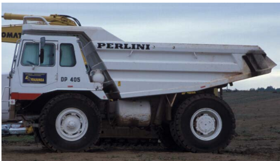
Figura B7. Dumper Perlini, encarregat de carregar la terra excavada per les giratòries.
