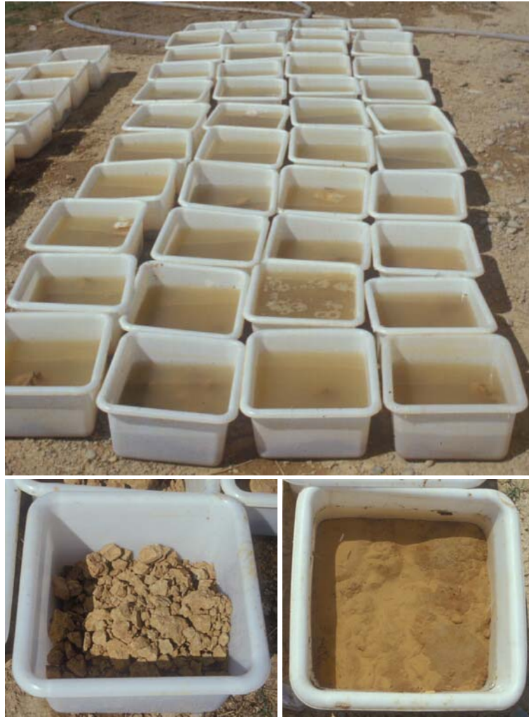
Figura B28. Cubetes plenes de sediment en remull (superior), i detalls d'una cubeta plena de sediment abans d'afegir l'aigua (inferior esquerra) i d'una cubeta un cop el sediment s'ha disgregat (inferior dreta).
