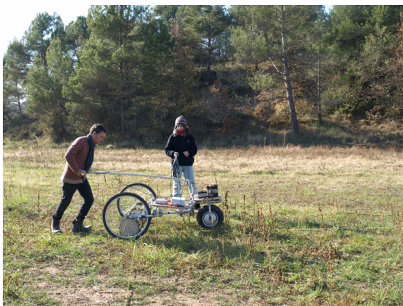
Figura 4. Tests operatius del prototipus v4. Es tracta d'un sistema de mesura de resistivitat del sòl d'alta velocitat que està desenvolupant l'empresa SOT Prospecció Arqueològica.
