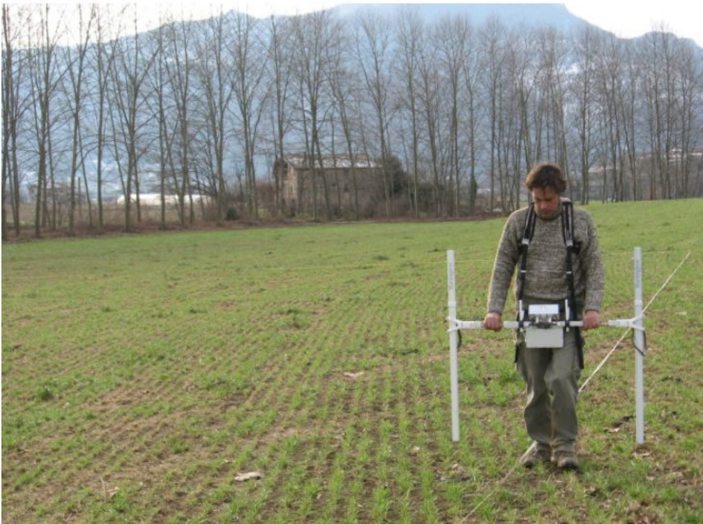
Figura 44. Sistema doble Bartington G601 amb 1m entre sensors durant les tasques de prospecció a la zona sud.
