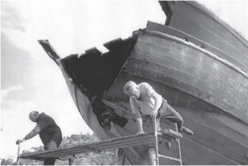
Gaspar Lloret i un operari retallant la popa d'un bastiment per fer-la plana (Roses, 1996). Museu de la Pesca. Col·lecció Gaspar Lloret.
