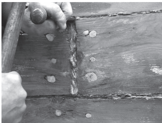
Detall de la introducció d'estopa en el junt del casc de l' Estrella Polar (Palamós). Museu de la Pesca.
