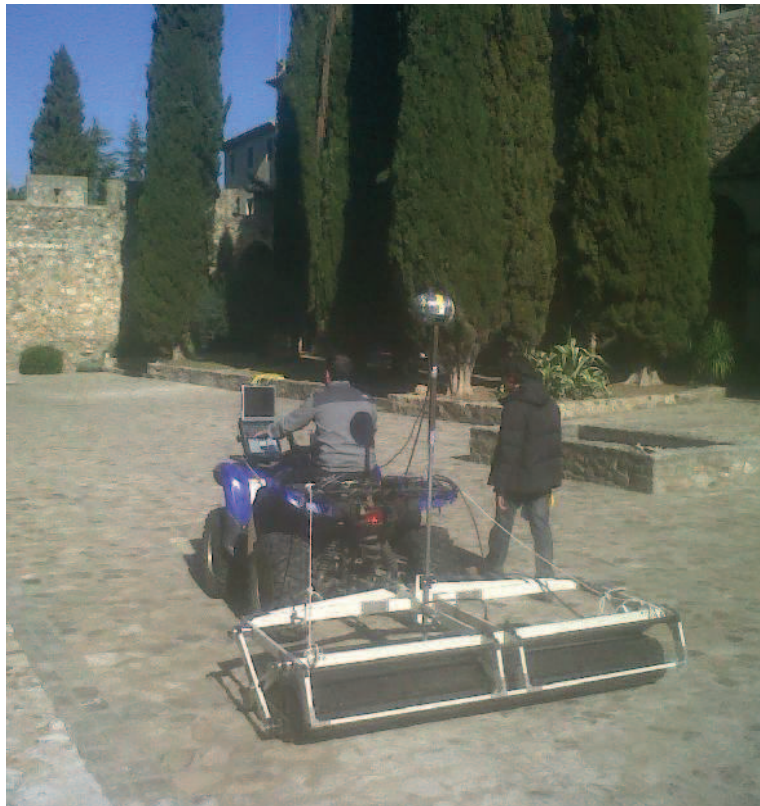
Figura 1. Sistema STREAM-X 200MHz durant la prospecció
