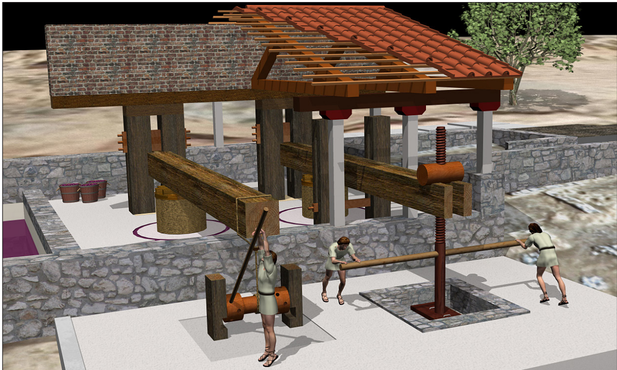
Figura 9. Reconstrucció tridimensional del gran torcularium superior de Vallmora i detall del funcionament dels dos sistemes de maniobra de les premses romanes de biga (Infografia 3D: F. Bayés i Colomer / A. Martín i Oliveras, 2008).
