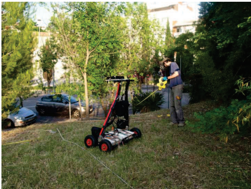
Figura 2. Sistema IDS Hi-Mod de doble antena durant les feines da camp.
