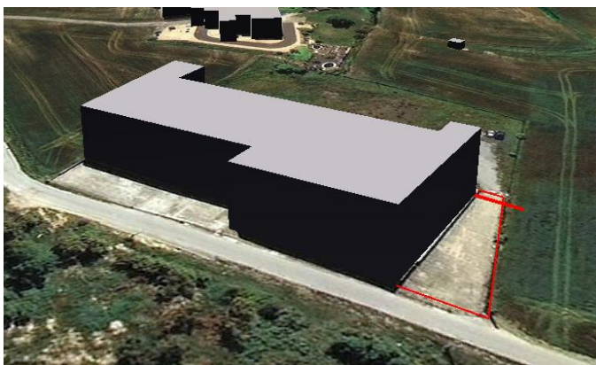
Fig 11. Situació de la rasa de fonamentació transversal.
