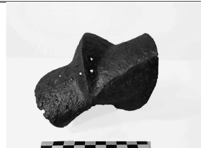
Fotografia lateral, s'observa el punt d'inflexió del dobleg, s'han reintegrat zones amb Arametel. Es poden observar millor les 3 perforacions a la part frontal.
