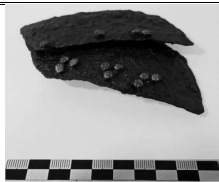
Fotografia detall de dues plaques juntes per la corrosió.
