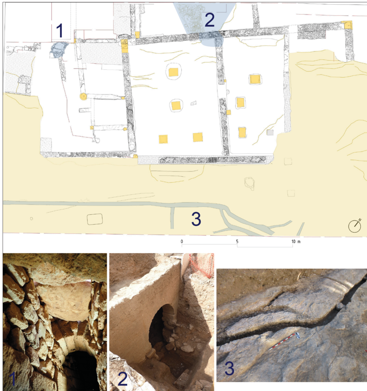
Figura 3. Planta amb la situació de les diverses construccions relacionades amb la gestió de les aigües subterrànies i superficials. (Sota) Interior de la conducció, vista de l'arcada associada a la cavitat natural i detall dels canals de drenatge (fotos de l'autora).
