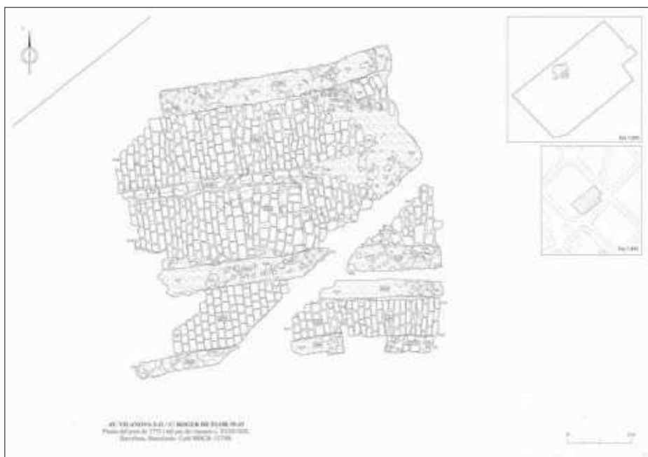
Figura 6. Planta del pont construït damunt el rec Comtal el 1775. A la part baixa de la imatge, s'observa el pas reservat per als vianants, fruit d'una ampliació feta a finals del segle XVIII, o més probablement, a la primera meitat del segle XIX. Planimetria: Xavier Carlús. Digitalització: Ignasi Camps
