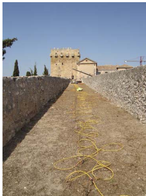
Fotografias 5 y 6. Fotografias del perfil 3 de tomografía eléctrica realizado justo antes de la zona del material deslizado.
