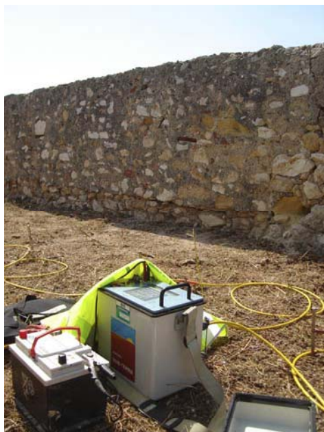
Fotografias 5 y 6. Fotografias del perfil 3 de tomografía eléctrica realizado justo antes de la zona del material deslizado.
