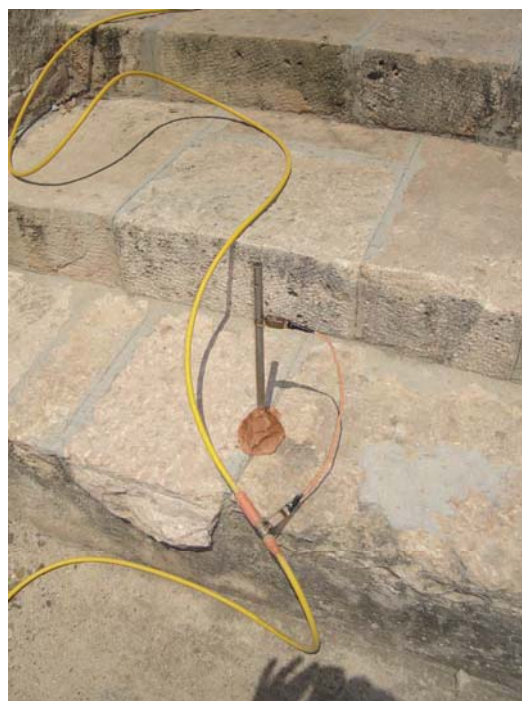
Fotografias 3 i 4. Fotografias del perfil 2 de tomografía eléctrica. A la izquierda, perfil 2 donde se ve como va ser necesario superar escalas para poder extender los 123 metros de perfil. A la derecha, fotografía de como el electrodo se clava sobre el pavimento y se fija al suelo con arcilla para tener un buen contacto y una respuesta aceptable.
