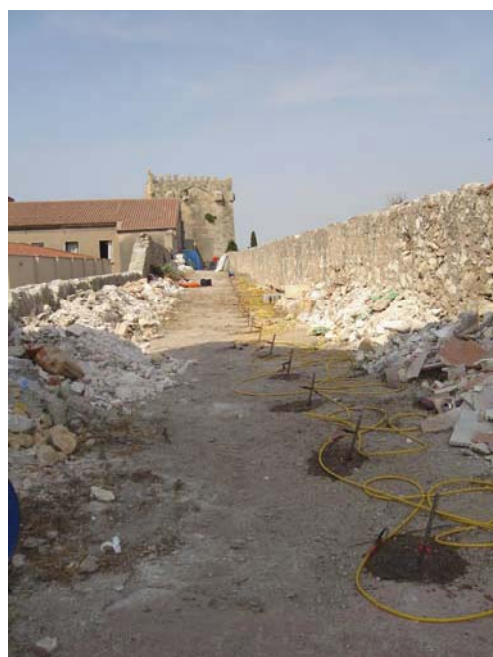
Fotografias 7 y 8. Fotografias del perfil 4 que muestra como se va a superar la ubicación del perfil sobre el pavimento con la utilización de arcilla y agua, que mejora el contacto con el terreno. Perfil ubicado entre el Palacio de l'Arquebispadó y el Archivo Diocesano.
