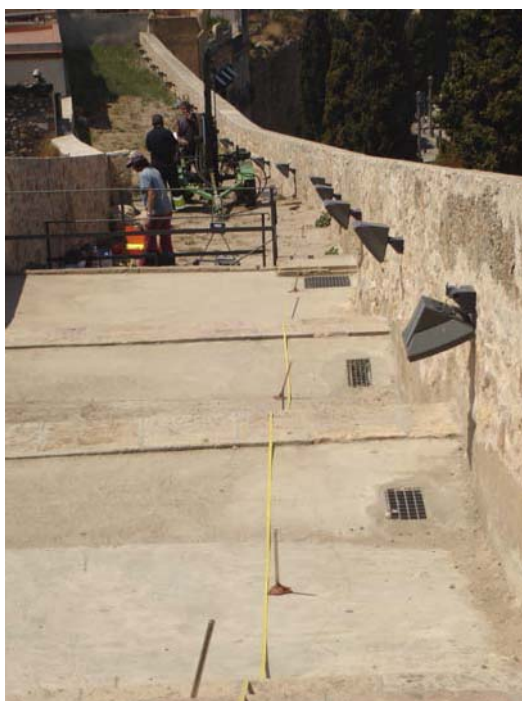
Fotografias 3 i 4. Fotografias del perfil 2 de tomografía eléctrica. A la izquierda, perfil 2 donde se ve como va ser necesario superar escalas para poder extender los 123 metros de perfil. A la derecha, fotografía de como el electrodo se clava sobre el pavimento y se fija al suelo con arcilla para tener un buen contacto y una respuesta aceptable.
