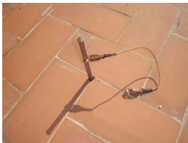
Fotografias 9 y 10. Fotografias del perfil 5 realizado sobre el suelo embaldosado. Imagen de los electrodos colocados cada metro a lo largo de una línea recta.
