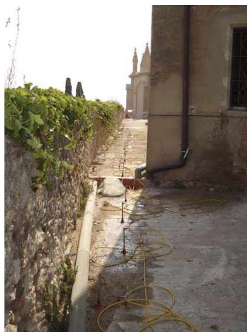
Fotografias 7 y 8. Fotografias del perfil 4 que muestra como se va a superar la ubicación del perfil sobre el pavimento con la utilización de arcilla y agua, que mejora el contacto con el terreno. Perfil ubicado entre el Palacio de l'Arquebispadó y el Archivo Diocesano.
