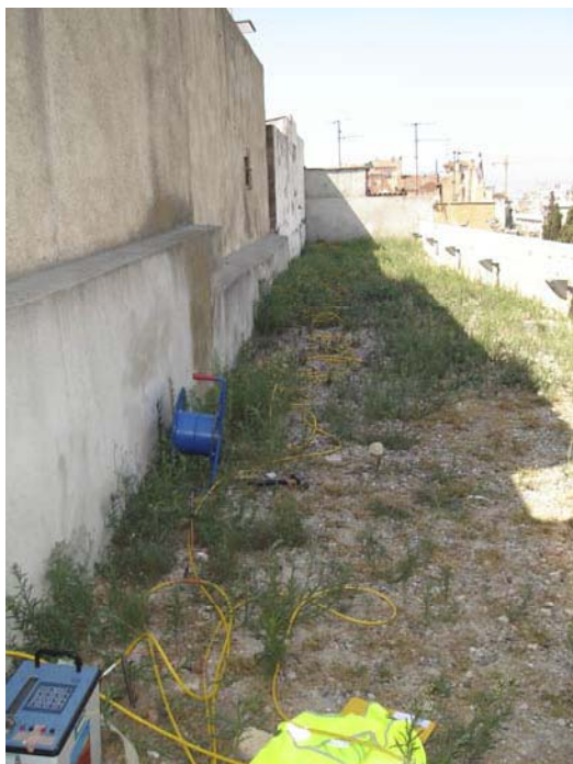
Fotografias 1 i 2. Fotografias del perfil 1 de tomografía eléctrica localizada en la zona del calle Salines.
