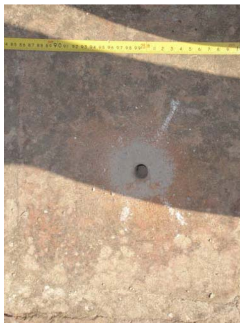
Fotografias 11 y 12. Fotografias del perfil 6 donde se muestra como se perforó el terreno y la perforación posterior donde se ubican los diferentes electrodos.
