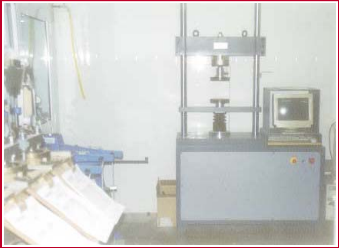
A la izquierda aparatos de edómetro y al fondo prensa automática multiensayo de 20 Tn. servocontrolada.
