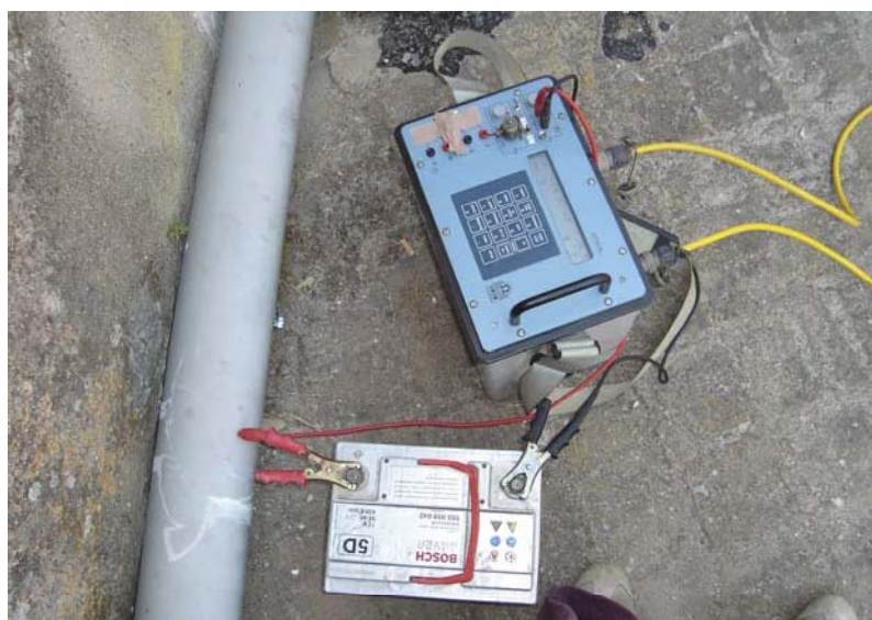
Figura 6. Fotografía del resistivímetro utilizado por SUB-TERRA, que muestra el valor de la intensidad eléctrica que introduce el aparato al medio, y la medida del potencial eléctrico.
