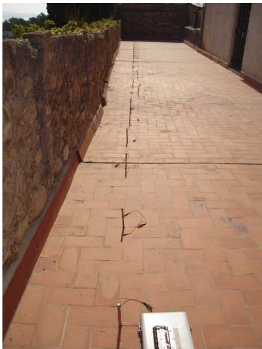
Fotografias 9 y 10. Fotografias del perfil 5 realizado sobre el suelo embaldosado. Imagen de los electrodos colocados cada metro a lo largo de una línea recta.
