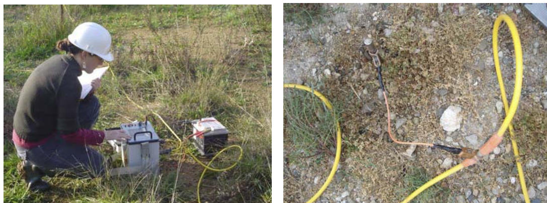
Figuras 7 y 8. A la izquierda, fotografía de una técnica de SUB-TERRA con el equipo de tomografía eléctrica (batería, cables que unen los electrodos, cables de conexión con el equipo central). A la derecha, imagen de la conexión entre un electrodo y el cable que conecta con el equipo central de medida (cable amarillo y conexión naranja).
