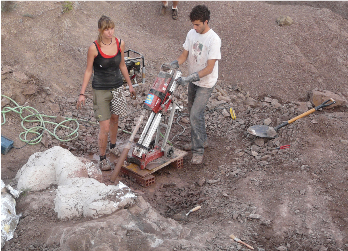
Figura 4. Per tal d'utilitzar el sistema del ciment expansiu en l'extracció de l'esquelet del mirador es van fer un conjunt de forats al voltant del perímetre del fòssil amb un trepant amb una broca de corona de diamant
