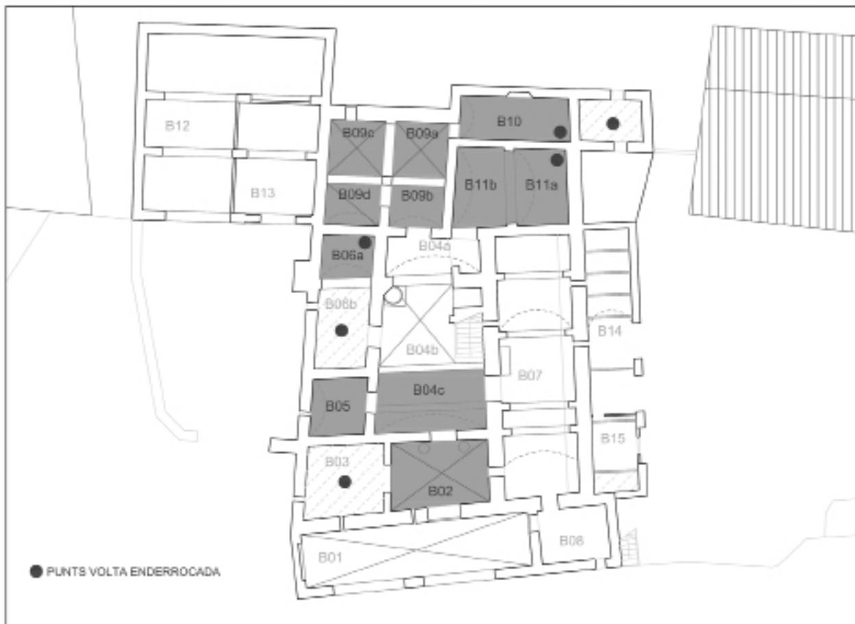
Figura 4. Àmbits de la planta baixa en els quals es va intervenir a nivell de la volta de coberta.
