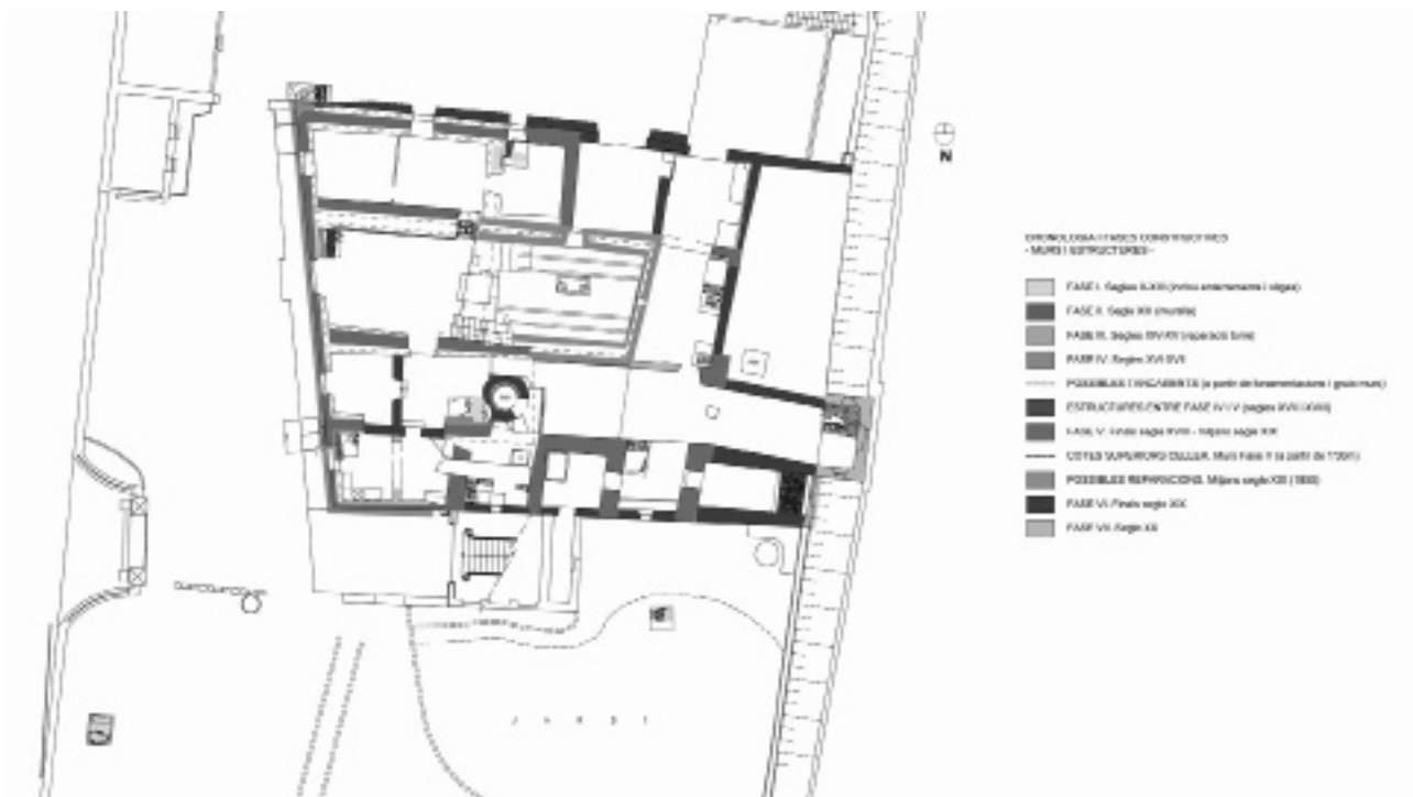
Figura 3. Fases constructives de la planta baixa.
