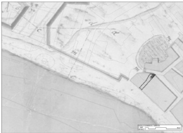
Figura 7. Superposició del cadastral actual sobre el gravat del 1784, que permet encaixar la parcel·la en l'illa de cases situada més al SW del raval.
