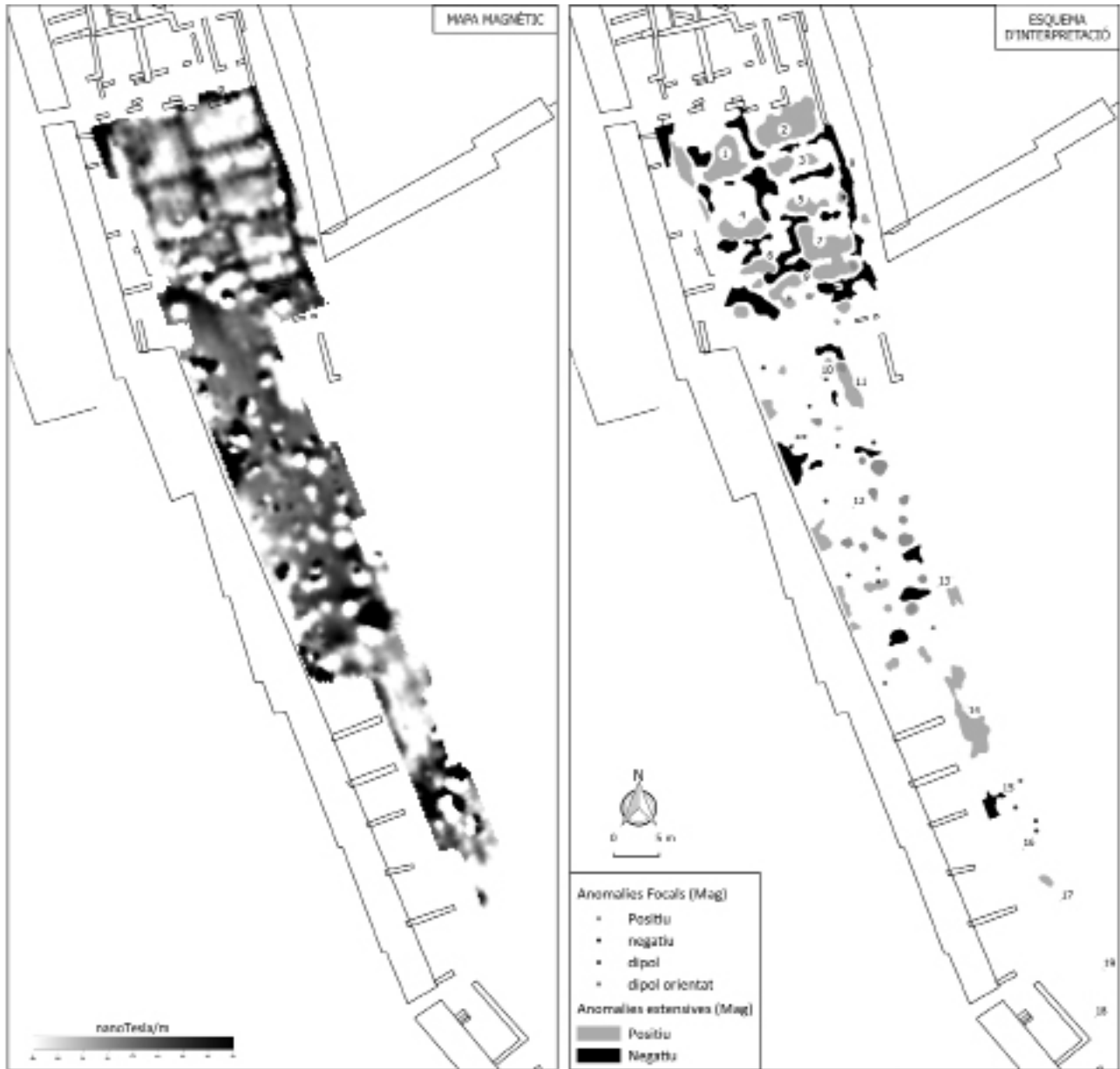
Figura 5. Mapa magnètic expressat en escala de grisos (esquerra). Esquema d'interpretació de les anomalies detectades.
