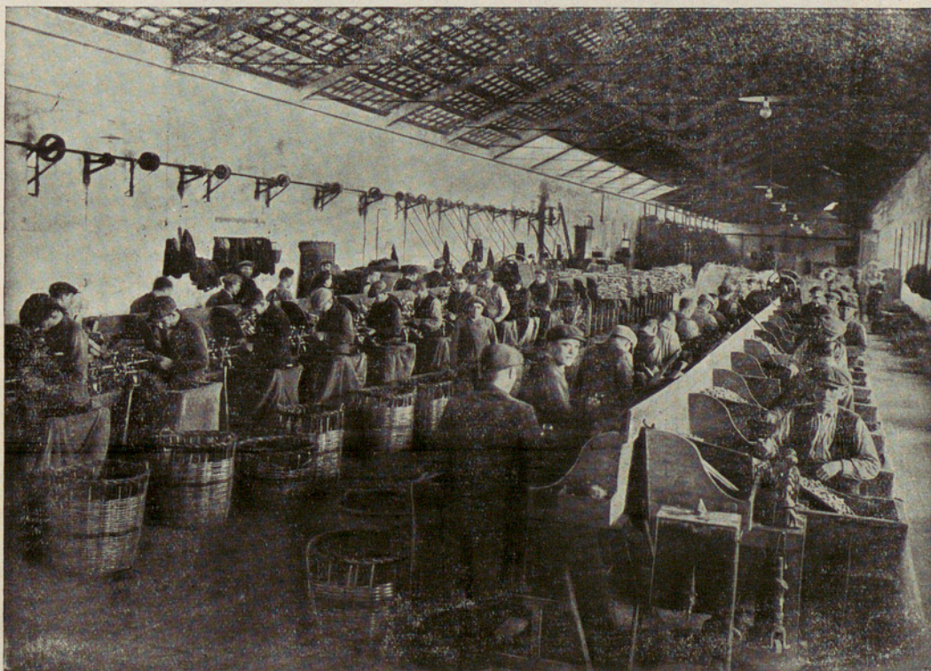
Fabricación de tapones con máquinas de taladro
